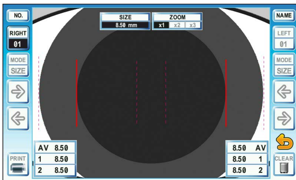
Рисунок 34 – Экран результатов измерения в режиме SIZE
