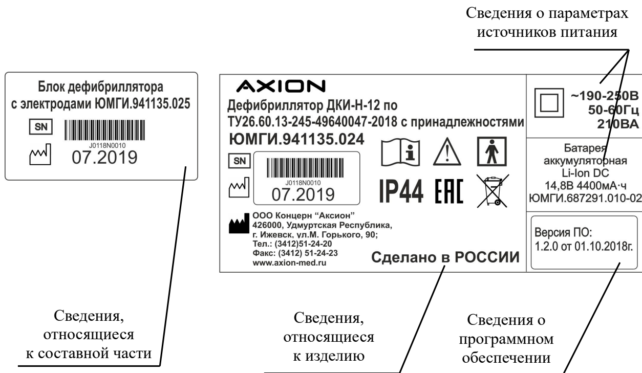
Рисунок 11 – Этикетки на задней части блока дефибриллятора с электродами
