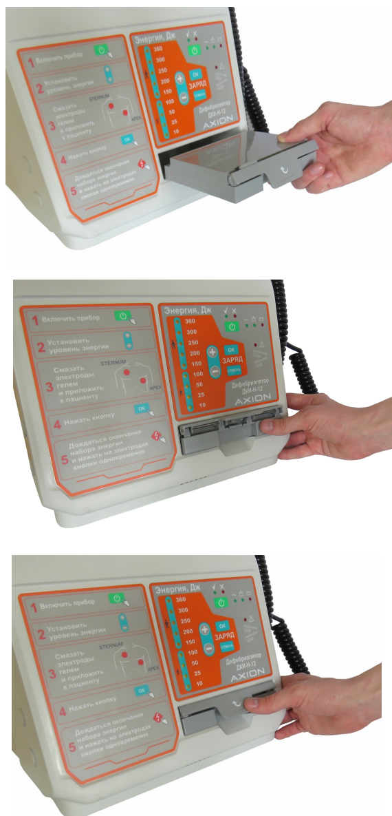
Рисунок 16 – Установка аккумуляторной батареи
