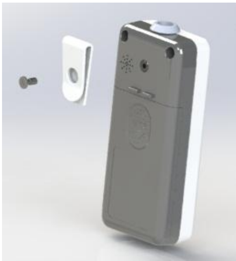
Рисунок 2.8 – Крепление кронштейна к пульсоксиметру
