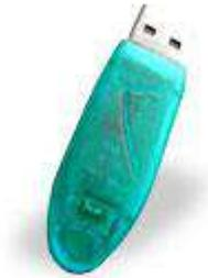
Перед первым запуском программы АрхиМед необходимо установить ключ в свободный USB-порт компьютера (питание компьютера отключать не обязательно). При успешном распознавании компьютером на нем загорается зеленый индикатор. Система готова к работе. Извлечение ключа автоматически переводит программу в демонстрационный режим с ограниченными возможностями работы.
